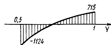
Фиг. 34. Эпюра напряжения \sigma_{\varphi} по оси Y .
